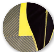
bande rétro réfléchissante microbille segmentée thermocollée
